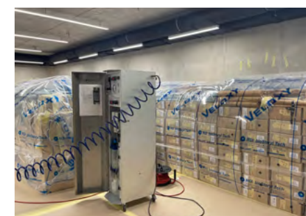
Fot. 72. Przykład procesu dezynsekcji materiałów archiwalnych metodą beztlenową (anoksją).
