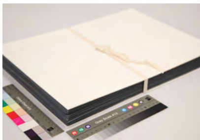
Fot. 67. Księga po demontażu z kartami umieszczonymi w obwolucie ochronnej, została dodatkowo wyposażona w podkładki z tektury i przewiązana tasiemką.
