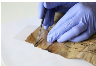
Fot. 37. Elementy metalowe tj. spinacze, zszywki, powodują uszkodzenia chemiczne i mechaniczne kart i okładek.
