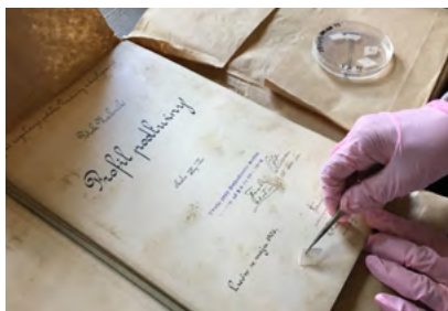
Fot. 70. Przykład poboru próbek metodą wymazową przy użyciu sterylnej bibuły.
